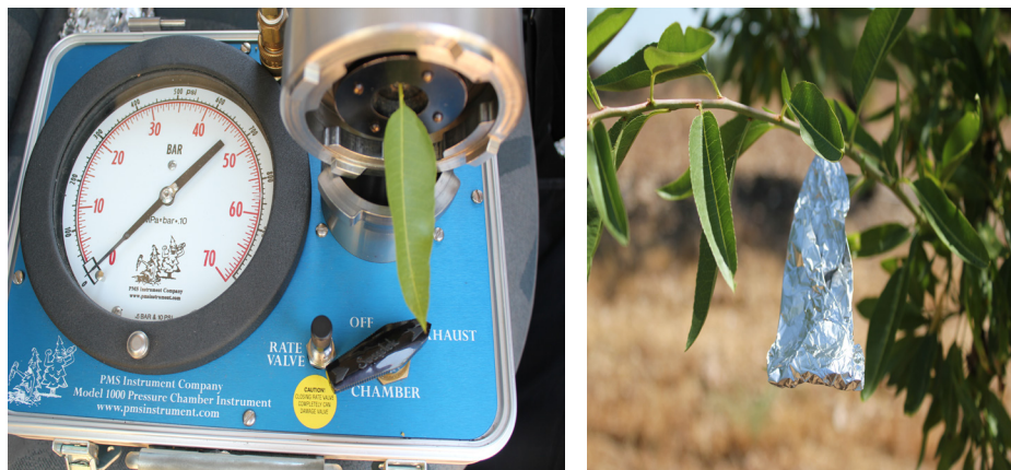
Figura 8.2 Câmara de pressão (esquerda) e folha coberta para posterior medição do potencial hídrico do ramo (direita)
